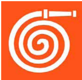
ABRIGO DE MANGUEIRA OU HIDRANTE
